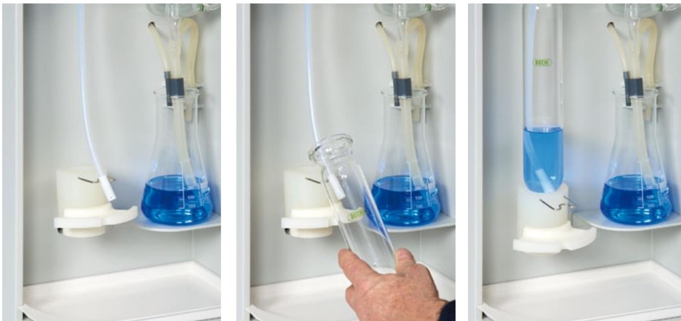
O nosso adaptador prático garante que as nossas unidades de destilação de vapor de água behrotest® também possam utilizar tubos de digestão de fabricante que diverjam da medida standard.
