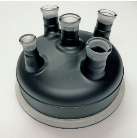
Reaktor und Deckel mit UV undurchlässiger Sicherheitsbeschichtung Reactor and lid with an UV blocking safety layer
