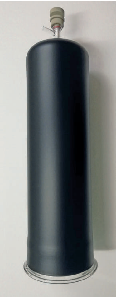
Reaktor und Deckel mit UV undurchlässiger Sicherheitsbeschichtung Reactor and lid with an UV blocking safety layer
